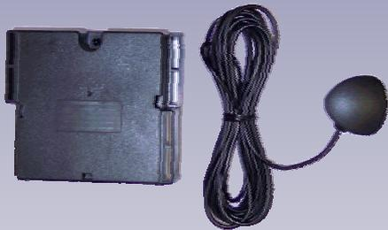
**Localisation :** Avec l'utilisation combinée du GSM et du GPS, le système Cg-G2i permet de localiser et de suivre votre véhicule en temps réel, soit sur un ordinateur grâce au logiciel de cartographie CGG2i-Track, soit directement sur votre GSM (GSMService).
